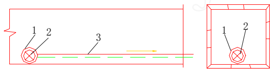
附图 3-1 漏光试验法检查系统
